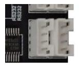
描述: 2.0mm 4pin座子,信号分别为5V, RX, TX, GND; RS232 电平接口。
